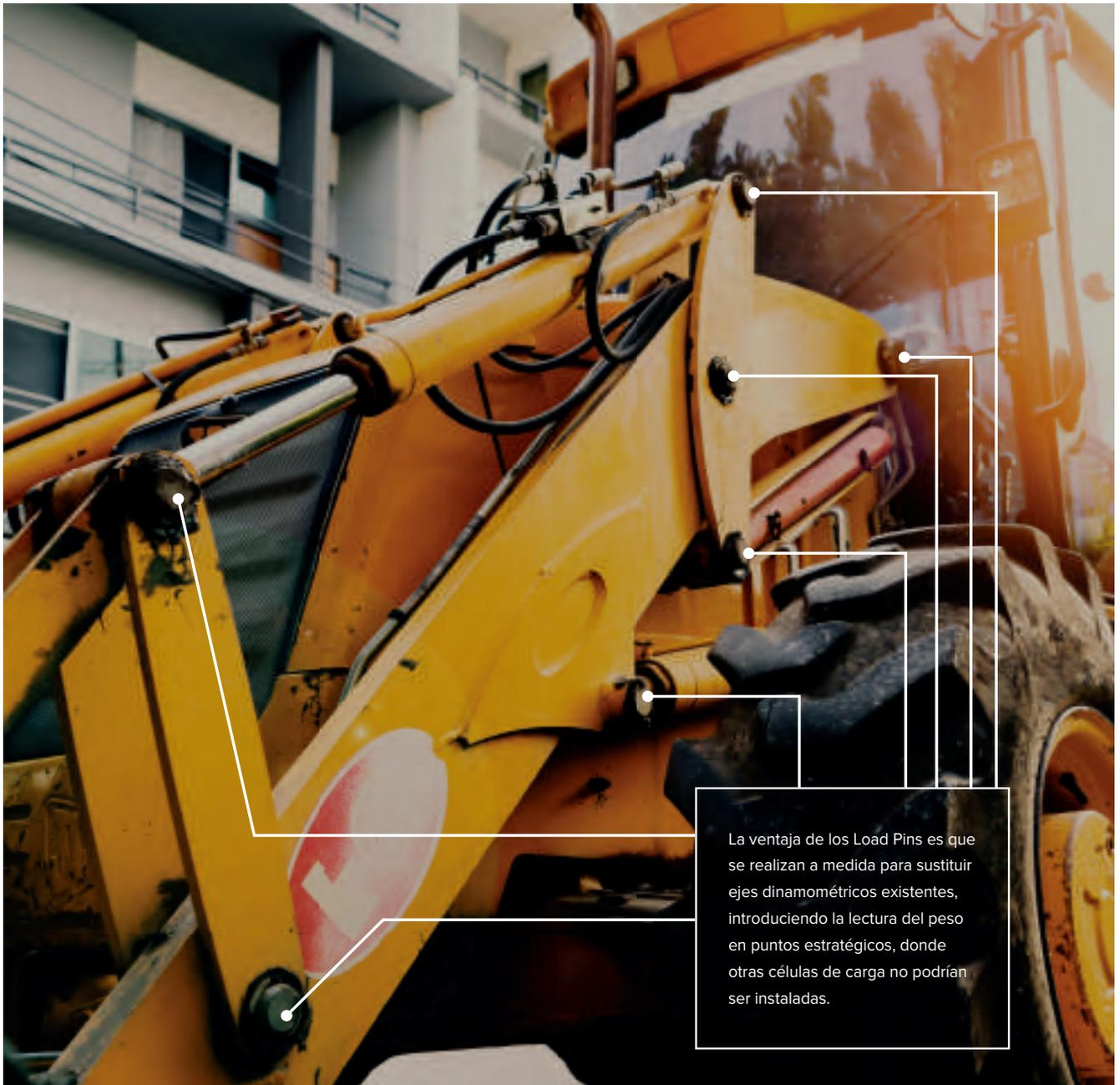
La ventaja de los Load Pins es que se realizan a medida para sustituir ejes dinamométricos existentes, introduciendo la lectura del peso en puntos estratégicos, donde otras células de carga no podrían ser instaladas.
