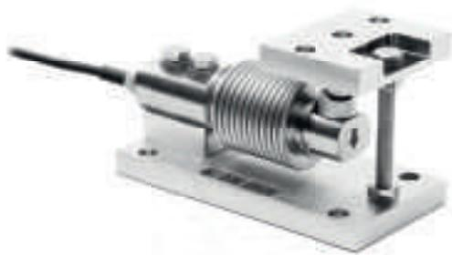
Kits de montaje con sistema antivuelco simple y compensación de las fuerzas laterales para células de carga de flexión serie FXC y FXD hasta 500 kg. Dotados de articulación esférica para el pesaje de alta precisión.
