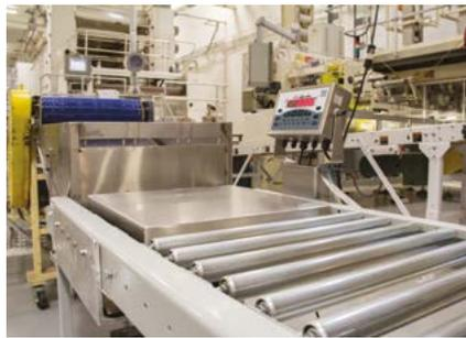
Mejoran la eficiencia de las aplicaciones de producción, clasificación y procesamiento de alimentos. Todos los envases se controlan y comprueban de manera continua para respetar el intervalo o el objetivo preestablecido.
